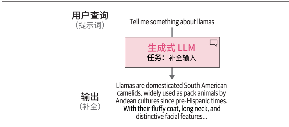
图 1-26: 生成式 LLM 接收输入并尝试补全。对于指令模型来说, 则不仅仅是自动补全, 而是试图回答问题
