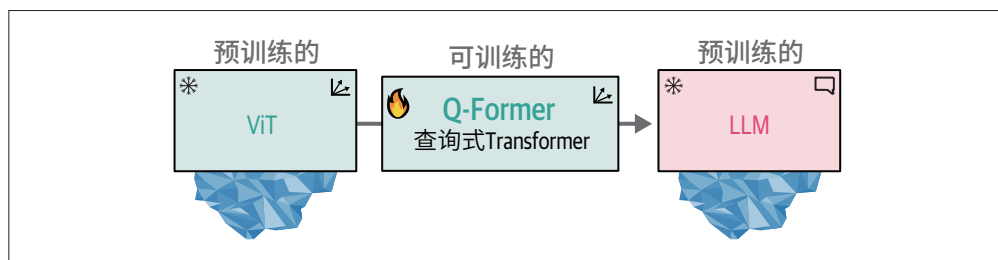
图 9-16：Q-Former 作为连接视觉（ViT）与文本（LLM）的桥梁，是系统中唯一需要训练的核心组件
