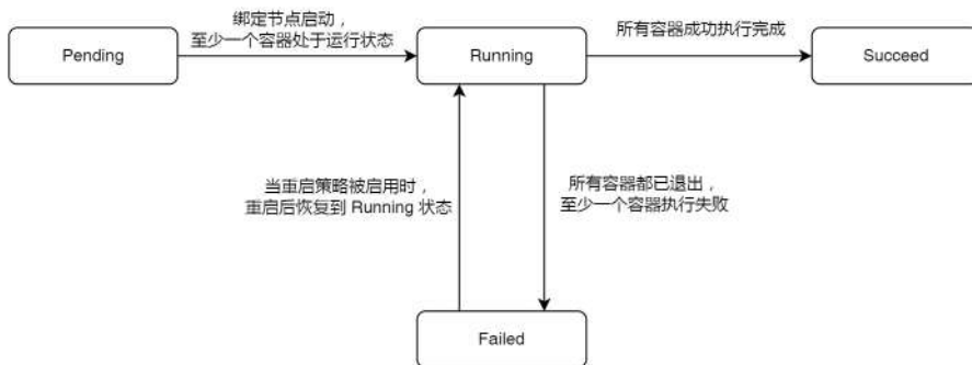
图 12-5 典型的 Pod 的生命周期状态流转
