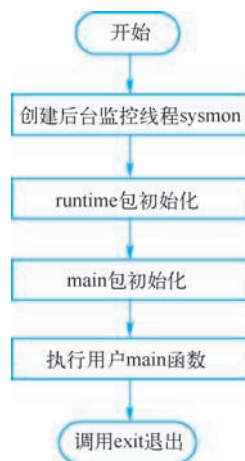
● 图 12-26 main 函数执行流程图
