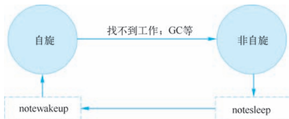
● 图 12-10 M 的状态流转图
